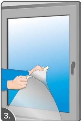
3. Lösen Sie den Schutzfilm von der Folie. Dies gelingt am besten, indem man zwei Streifen Klebefilm an einer Ecke befestigt und langsam auseinander zieht.
