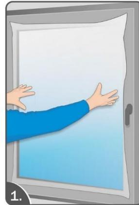
1. Messen Sie die Fenster aus. Bestellen Sie die Folie umlaufend ein bis zwei Millimeter kleiner als das Glasmaß (gemessen ab dem Dichtungsgummi)
