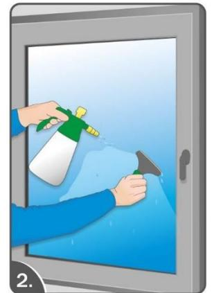
2. Sprühen Sie die Scheibe un-mittelbar vor der Montage mit dem Montagewasser ein, reinigen Sie diese gründlich mit einem Glasschaber und trocknen Sie die Scheibe und den Rahmen mit einem Küchentuch.
