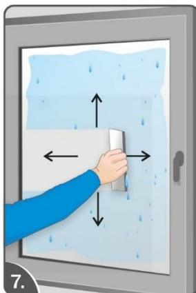
7. Glätten Sie die Folie von der Mitte nach außen, mittels einer Rakel. Hierbei ist ein gewisser Druck nötig, damit möglichst viel Wasser herausgerakelt wird.
