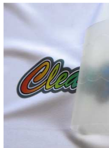
Trägerfolie abziehen, fertig!
